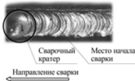
Рис. 9.4. Начало сварки при смене электрода.
