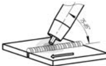
Рис. 8.5. Угол наклона горелки.
